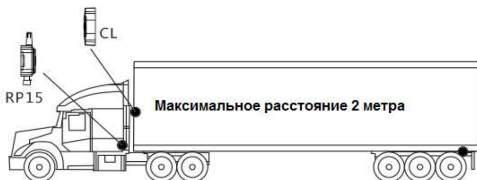
рис. 6.1. Установка модулей на прицеп
