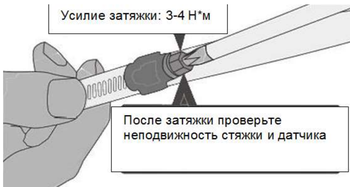
рис.5.8. Установка датчика
