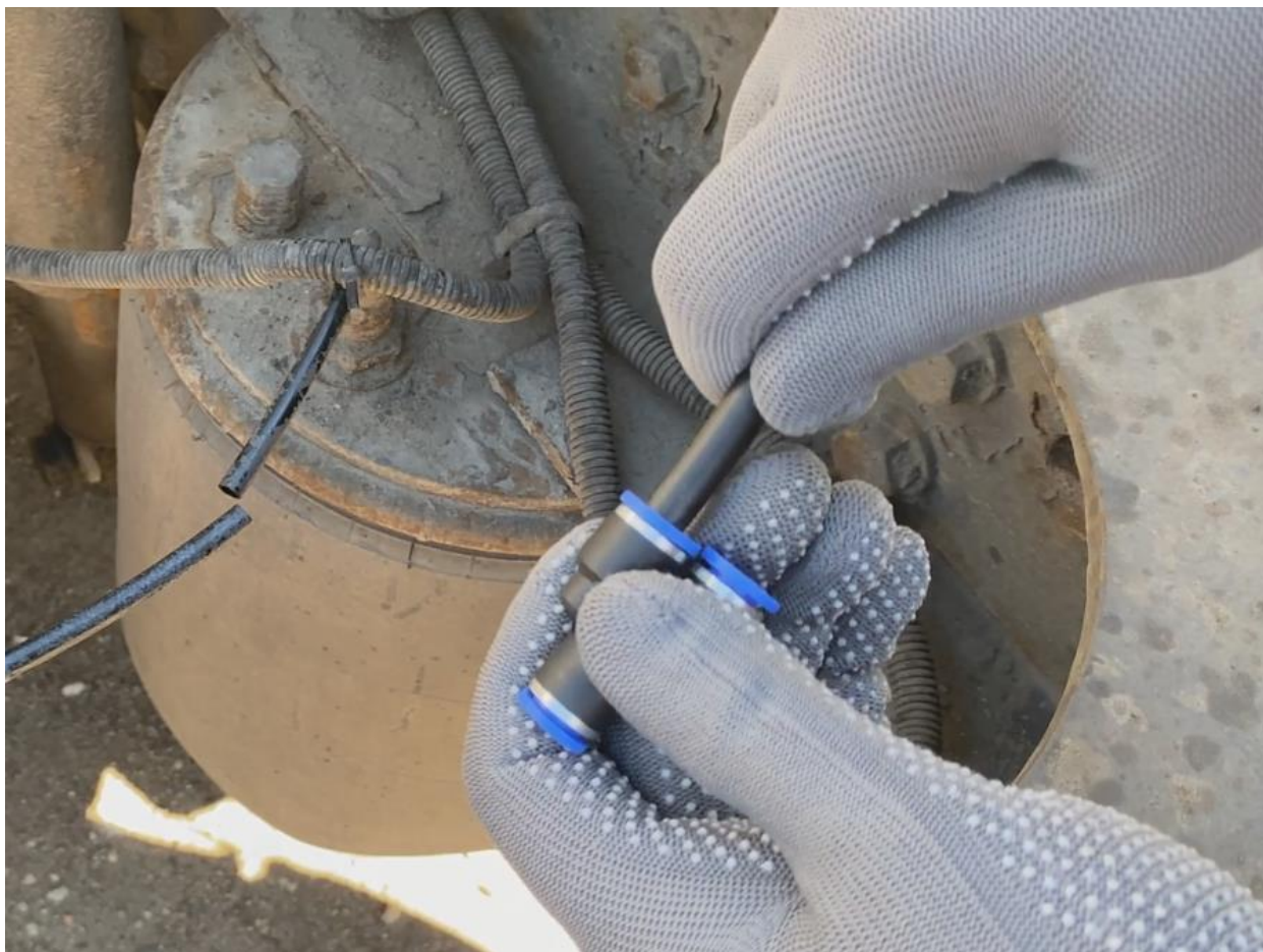
рис. 3.3. Установка пневмотрубки датчика в фитинг-тройник
