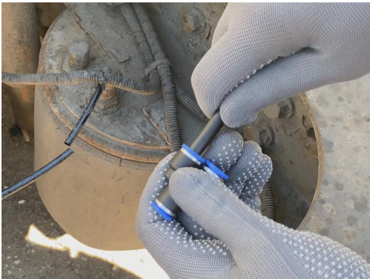
рис. 3.3. Установка пневмотрубки датчика в фитинг-тройник
