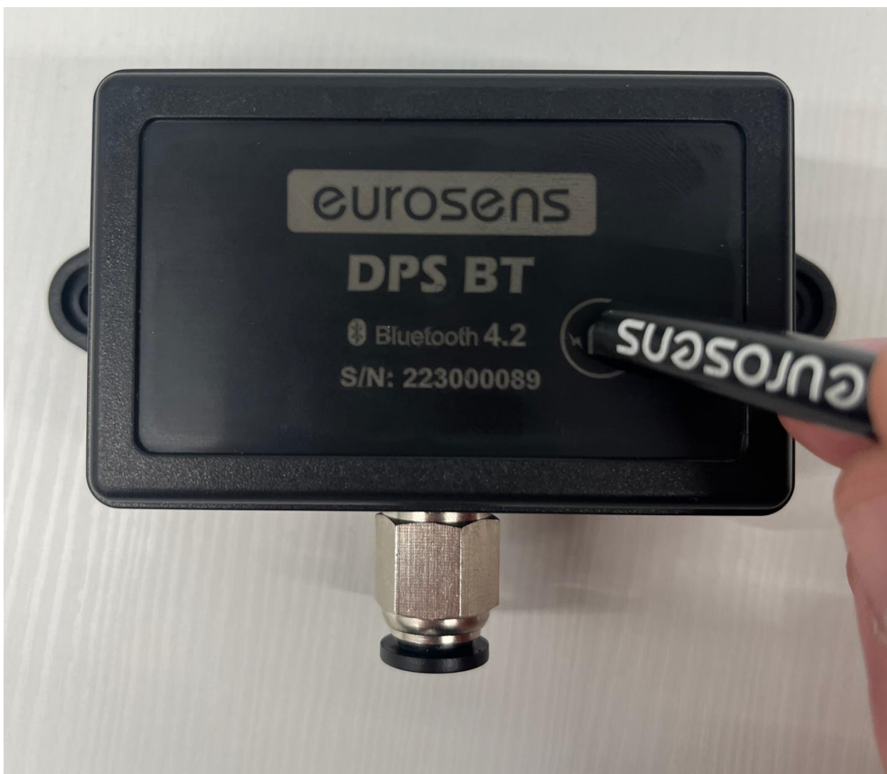
Рис. 5.2. Перевод датчика в активное состояние
