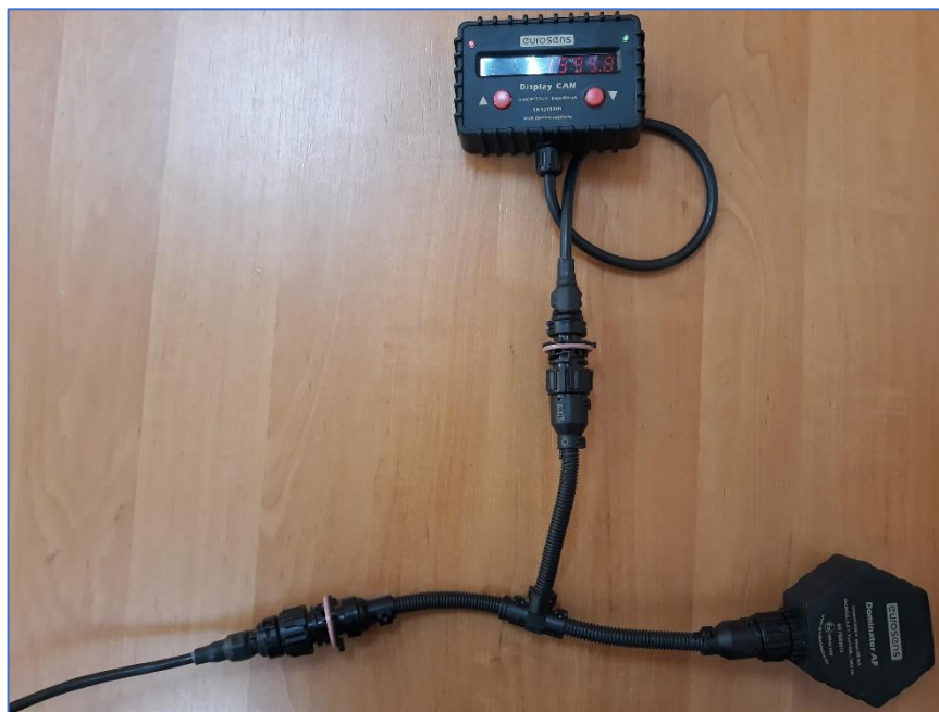
рис. 4.19. Соединение дисплея с аналоговым ДУТ
