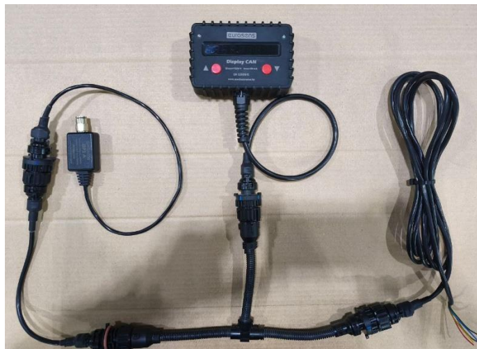
рис. 4.11. Соединение дисплея с аналоговым датчиком давления. Режим “Difference 01”
