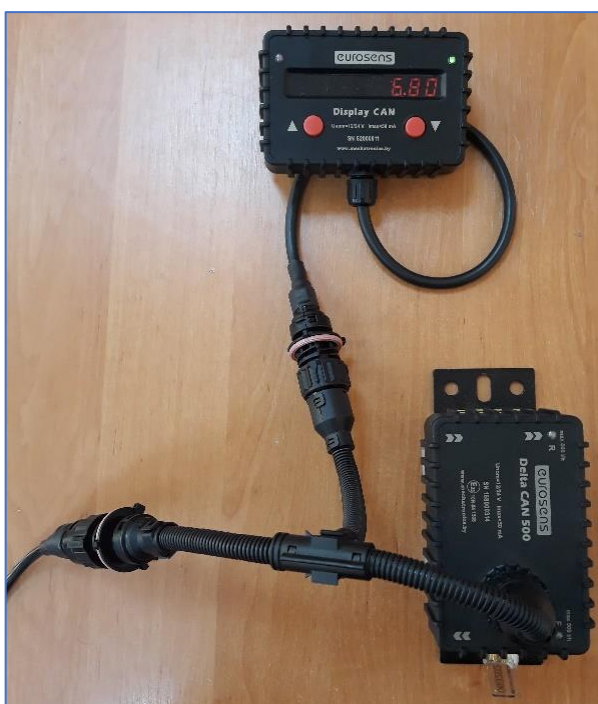
рис. 4.8. Соединение Display RS с расходомером. Режим “сумматор 1 расходомер”
