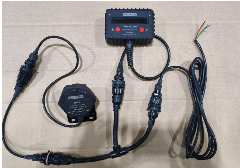
рис. 4.15. Соединение дисплея с аналоговым датчиком перемещения. Режим “Difference 02”
