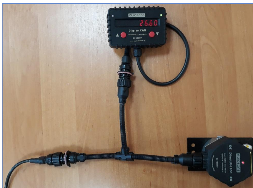
рис. 4.24. Подключение расходомера, работа по импульсу
