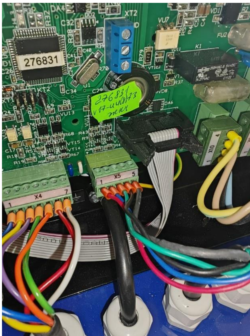
Рис.7. До подключения считывателя (Разъем X5. красный провод +5В, синий сигнал 1, зеленый сигнал 2, черный GND-, серый защитное экранирование).
