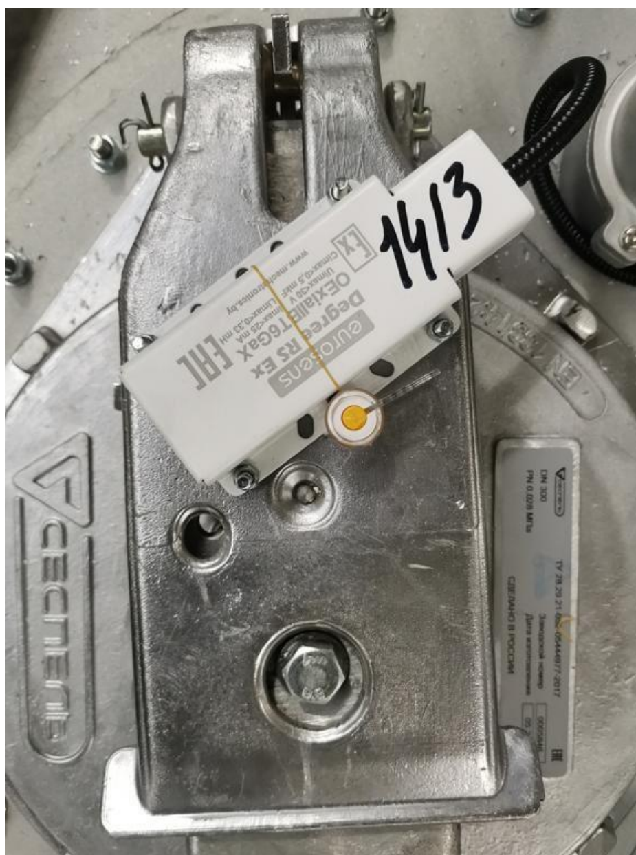
рис. 3.1. Использование eurosens Degree на бензовозе
