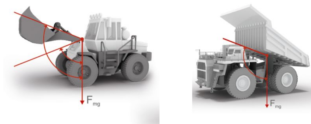
Рис. 3. Контроль изменения положения рабочего механизма - возможно
