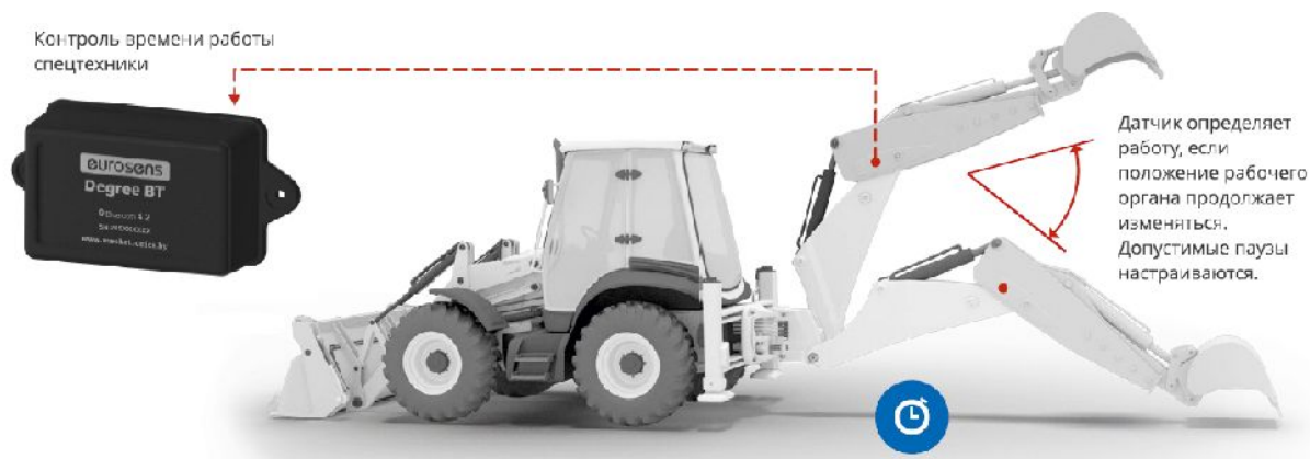
Рис. 10. Работа Eurosens Degree BT в режиме контроля стрелы
