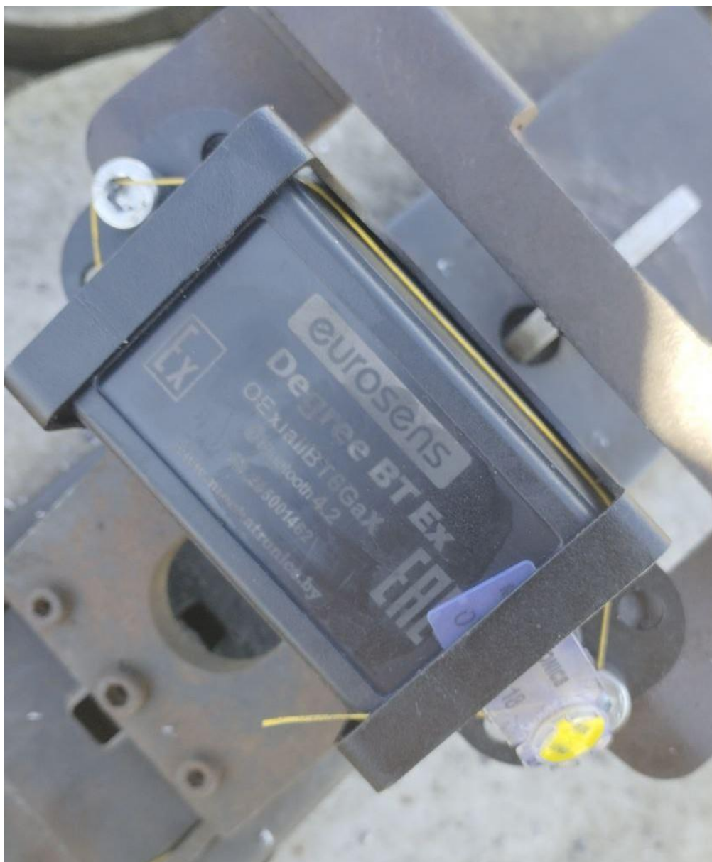
Рис. 27 Фото монтажа датчика с защитной крышкой
