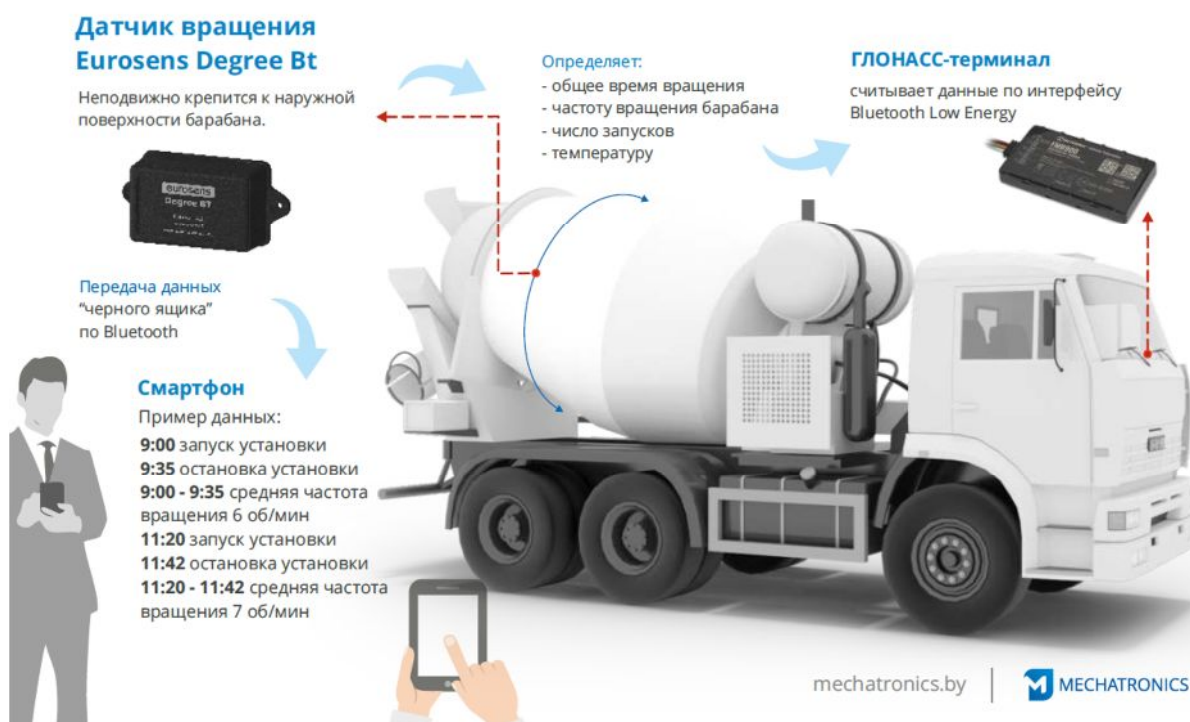
Рис. 9. Работа Eurosens Degree BT в режиме контроля бетоносмесителя
