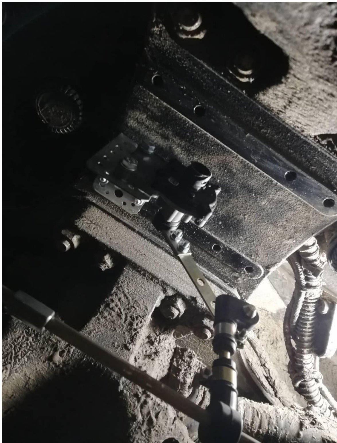
Рис. 2.6. Установка дополнительной тяги
