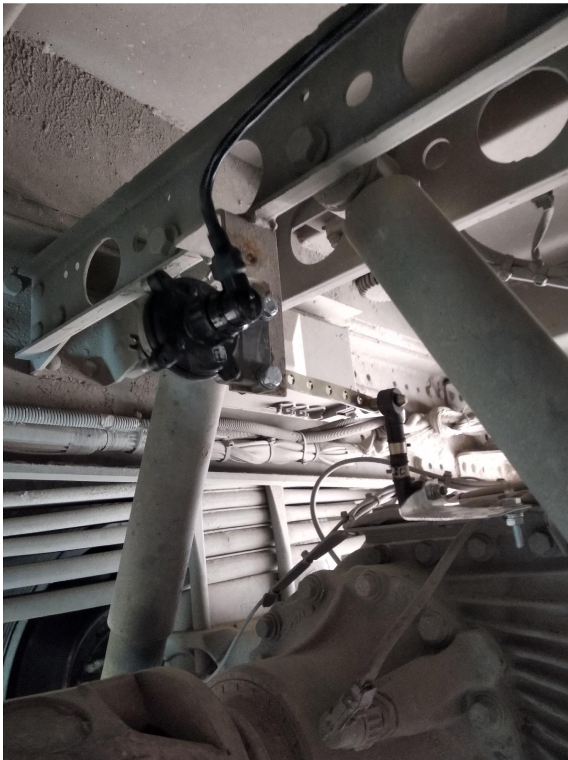
Рис. 2.8. Установка датчика на передний мост
