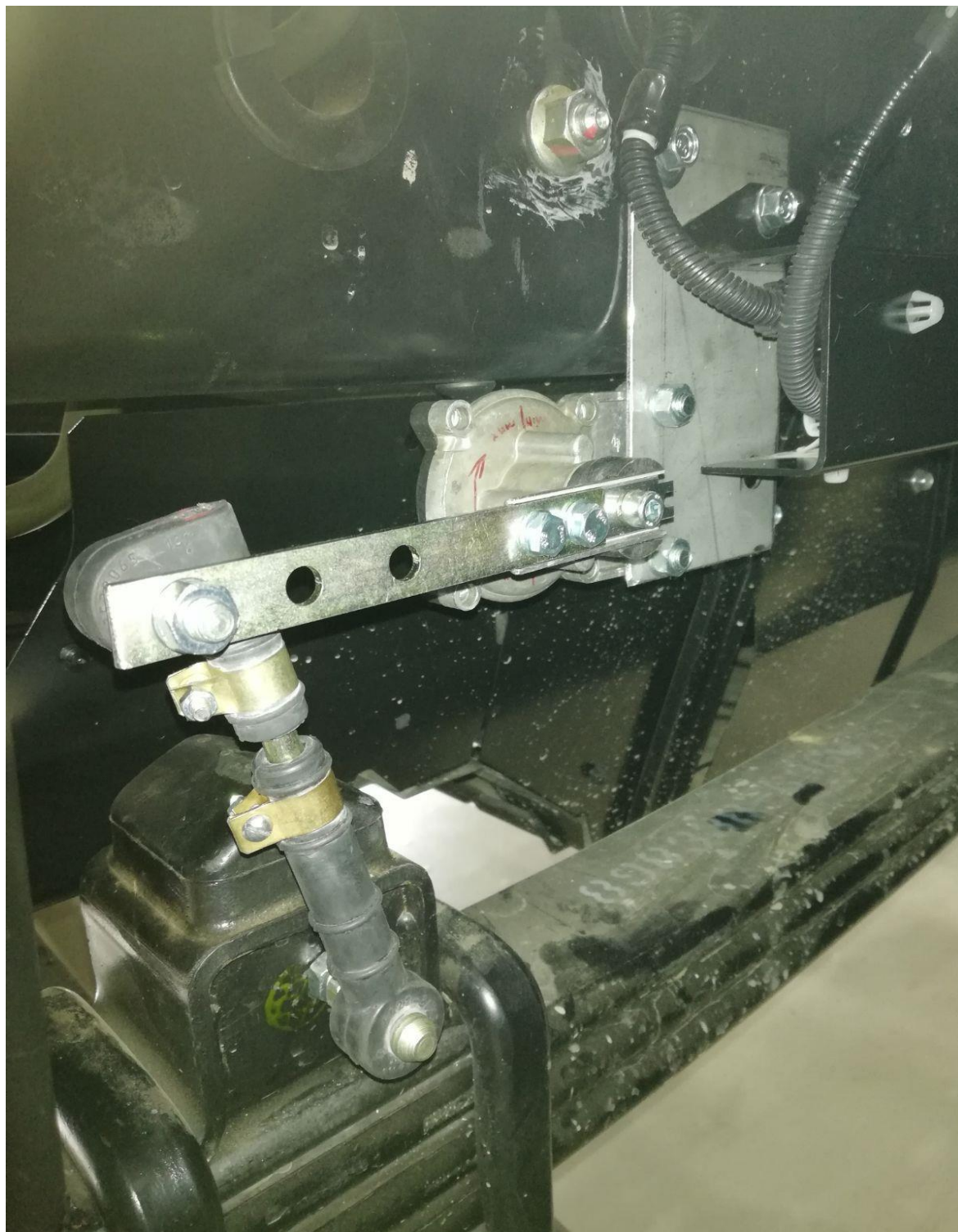
Рис. 2.7. Установка датчика на передний мост
