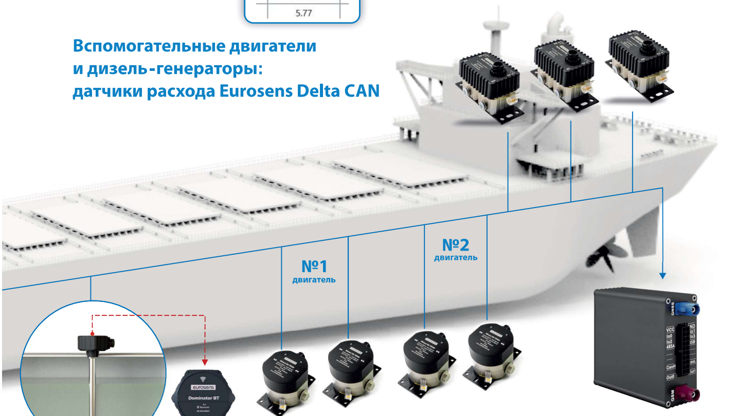
Основные двигатели №1 и №2 Датчики расхода Eurosens Direct CAN 3000 2 шт. на каждый двигатель (всего 4шт.)
