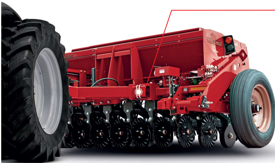
Eurosens Dottrack Беспроводная радиометка. Служит идентификатором навесного или прицепного орудия
